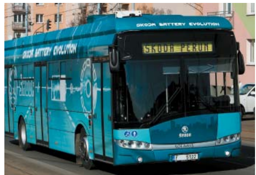
ŠKODA PERUN – Bateriový autobus / ŠKODA ELECTRIC a.s. 12metrový elektrobús Pure Electric RUNner (PERUN) funguje čistě na bateriový provoz a má dojezd až 150 km
